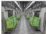
駅構内および地下鉄車内の照明を従来の蛍光灯からLEDに置き換えることで、照度を保ちつつも消費電力を削減します。
