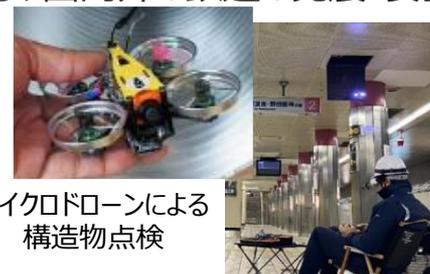
マイクロドローンによる構造物点検
