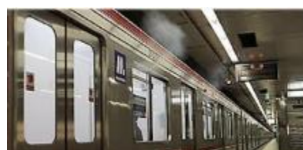
地下鉄車内での換気実験
